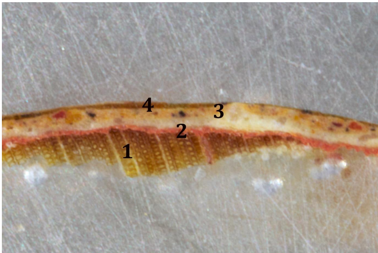
Fot. 12. Fotografia przekroju stratygraficznego próbki pobranej z bocznej powierzchni skrzydła drzwi wahadłowych.
